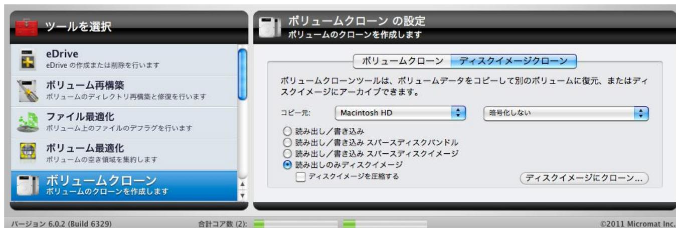
ディスクイメージクローンを作成するには、コピー元を選択して、ディスクイメージの種類を選択します。「ディスクイメージにクローン…」をクリックすると、ダイアログボックスが表示され、ディスクイメージを保存する場所を指定します。その後、TechTool Pro はコピー元ドライブの内容を .dmg ファイルにコピーし
