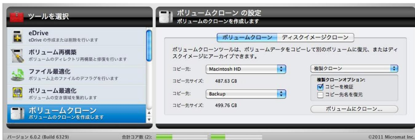
複製クローンを作成するには、ドロップダウンメニューから「複製クローン」を選択します。コピー元のサイズより大きな容量を持つディスク、またはパーティションがコピー先として表示されます。
