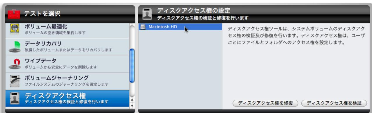
設定ウィンドウでアクセス権を検証/修復したいボリュームを選択し、「ディスクアクセス権を検証」、または「ディスクアクセス権を修復」ボタンをクリックします。アクセス権の検証、または修復が終了すると、不正なアクセス権が設定されているファイル、またはアクセス権が修復されたファイルがレポートウィンドウに表示されます。
