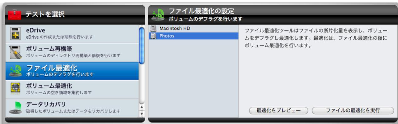
左側のボリュームリストから、検査または最適化を行いたいボリュームを選択します。「最適化をプレビュー」ボタンをクリックすると、選択されたボリュームの断片化量が表示されます。これが終わると、ステージの右側に断片化されているファイルのサイズと名前、断片化されているファイルの合計が表示されます。リスト内のファイル名をクリックすると、そのファイルのフルパスが表示され、「Finder に表示」ボタンをクリックすると、選択されているファイルが Finder に表示されます。
