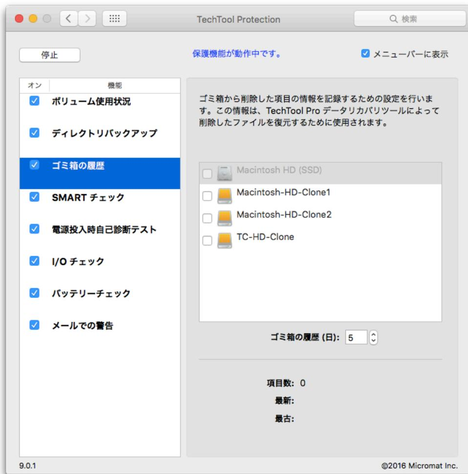
「ゴミ箱の履歴 (日)」フィールドに、削除されたファイルの履歴をとる期間 (日数) を設定します。期間内で削除されたファイルが上書きされていないならば、復元することが可能です。復元するには TechTool Pro の「データリカバリ」ツールを使用します。「データリカバリ」ツールの「ゴミ箱」タブから「ゴミ箱の履歴を表示」ボタンをクリックして、「ゴミ箱の履歴」ウインドウを表示します。復元したいファイルを選択して「復元」ボタンをクリックします。選択されたファイ
