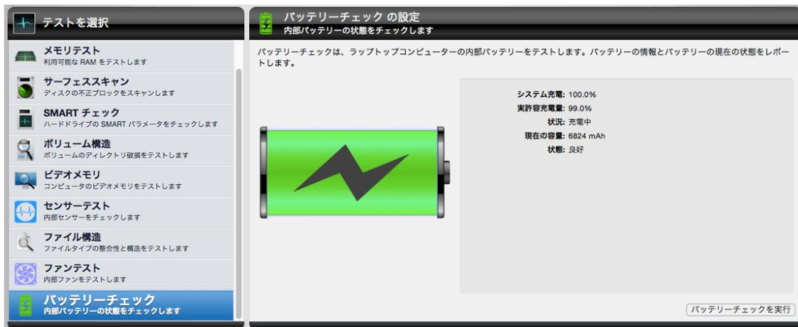
「バッテリーチェックを実行」ボタンをクリックすると、残りの充電量、充放電回数といった追加のバッテリーの診断結果が表示されます。もしバッテリーの状態が“サービスが必要”もしくは“失敗”になっている場合には、バッテリーの交換が必要です。もしお使いのノートブックのバッテリーがユーザによる交換ができない場合には、Apple 認定の修理センターでバッテリーの交換を行ってください。
