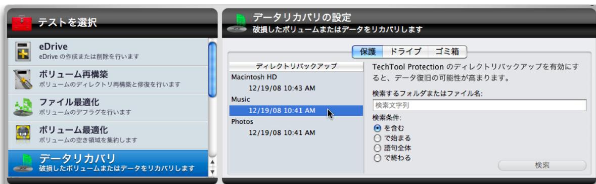
設定ウインドウの左側には、ディレクトリバックアップリストが表示されます。ボリューム名リストの下に、認識されているボリュームと関連付けられたディレクトリバックアップファイルと一緒にリストされます。ディレクトリバックアップファイルは作成された日付と時間で識別されます。新しいディレクトリバックアップファイルの方が直近の状態を最も正確に記録しているため、通常は一番新しいディレクトリバックアップファイルを選択します。TechTool Protection は 1 つのボリュームに最大で 3 つのディレクトリバックアップファイルを保存できます。古い方が不要な場合には削除してもかまいません。
