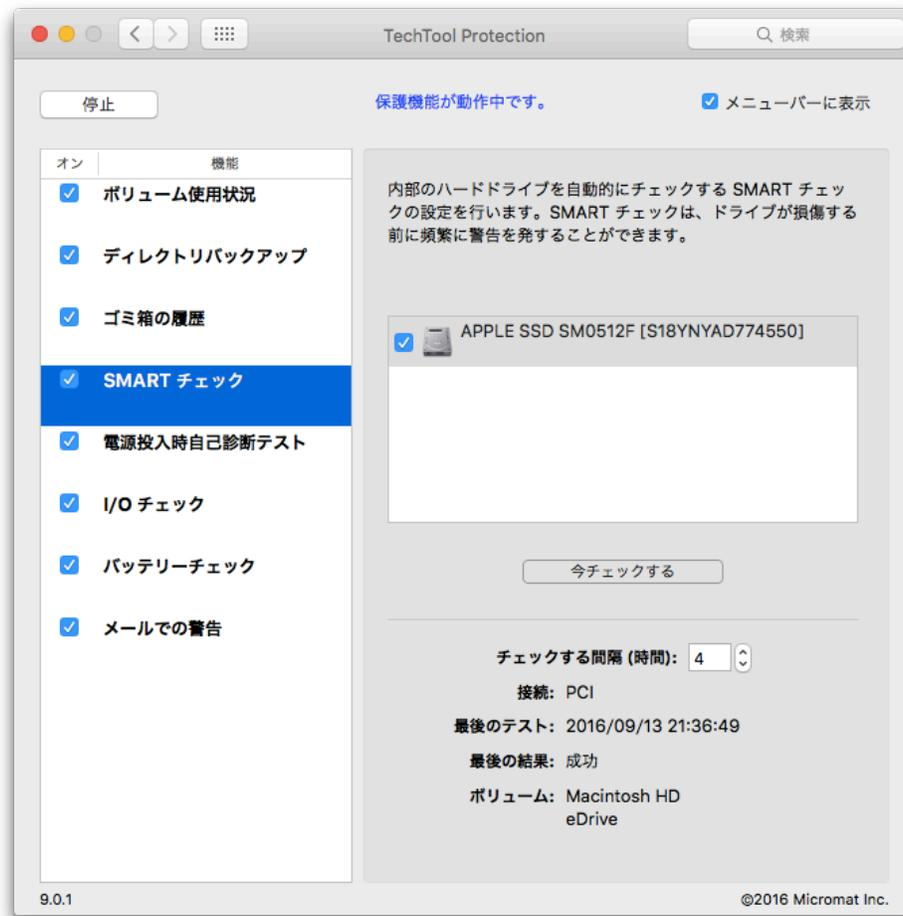
「オン」ボタンをクリックして SMART チェックを有効にします。自動でチェックしたいボリュームのチェックボックスをオンにします。「チェックする間隔」にチェックを行う時間を設定します。選択されているボリュームの SMART チェックを直ちに行うには、「今チェックする」ボタンをクリックします。「今チェックする」ボタンの下には以下の情報が表示されます。
