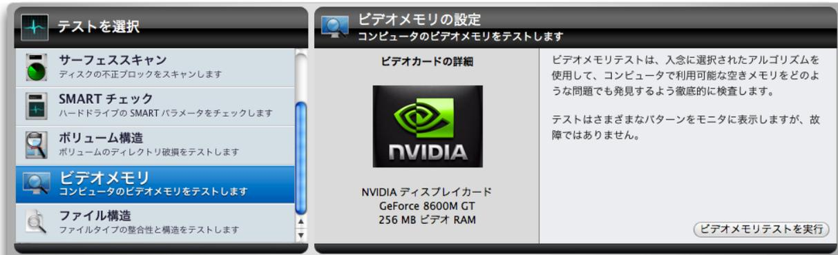
「ビデオメモリテストを実行」ボタンをクリックして、テストをキューに追加します。テストが実行されると、コンピュータのスクリーンに奇妙な色やパターンが表示されますが、これは正常な動作です。テストが完了すると、テスト結果がステージ上の「最後に実行したテスト」と「ビデオメモリテスト結果」画面に表示されます。
