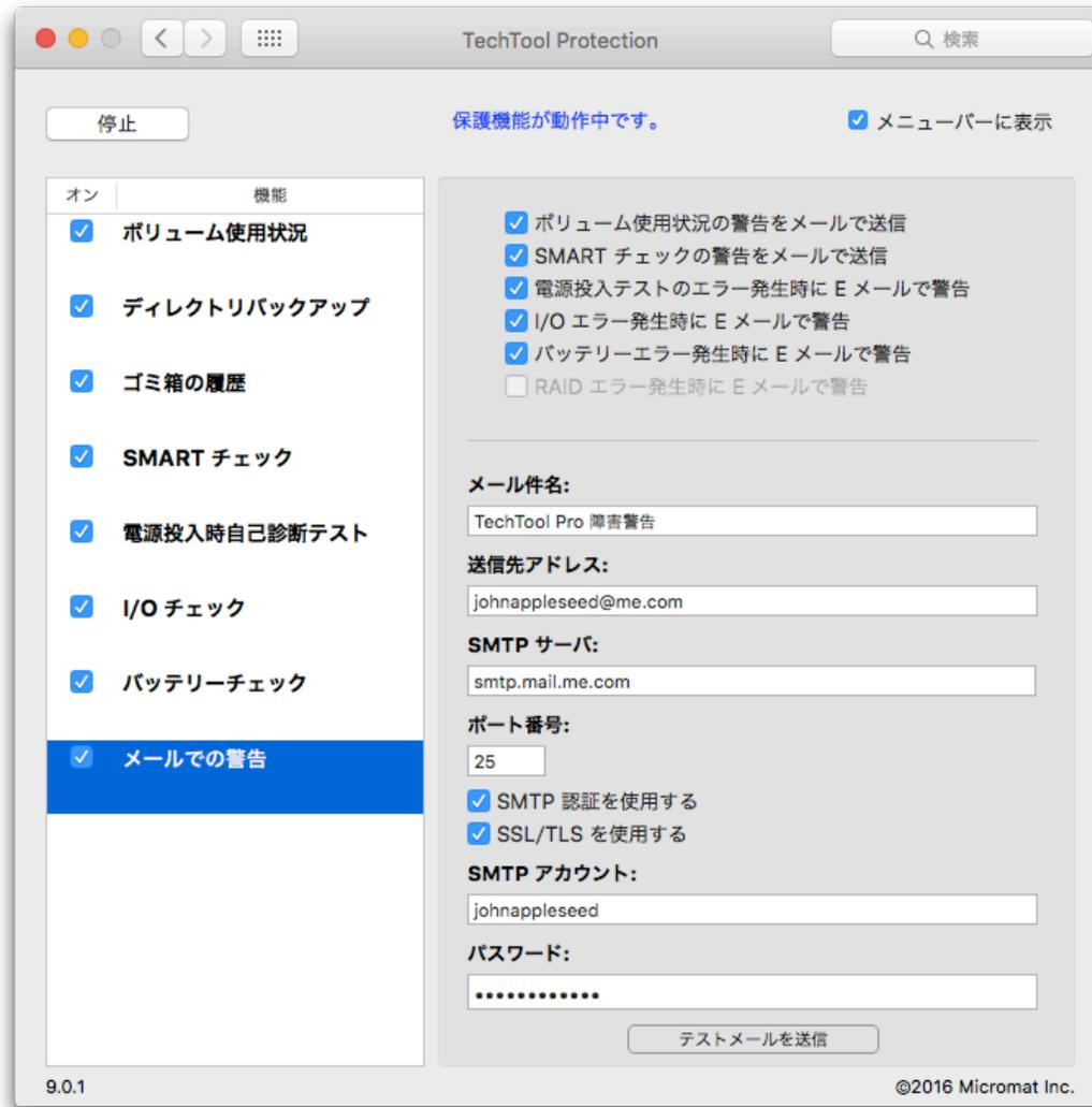
上記の情報を入力後、「オン」ボタンをクリックしてメールでの警告を有効にします。適切なチェックボックスをオンにして、警告をEメールで送信するイベントを選択します。
