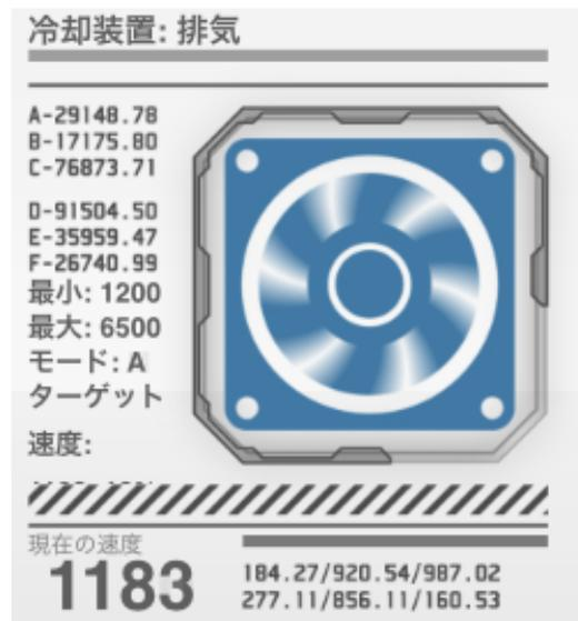
ファンテストを開始するには、「テスト」カテゴリから「ファンテスト」を選択して、「ファンテストを実行」ボタンをクリックします。ステージに各ファンのグラフィックが表示され、現在の回転速度、最小速度、最大速度がアニメーションと共に表示されます。テストは各ファンのテスト結果をテーブルにリストして終了します。
