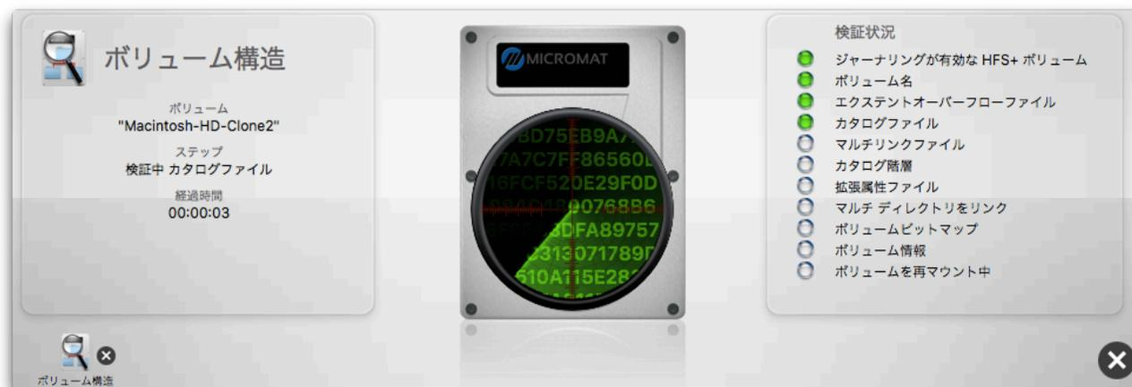
ステージの左側に、テストの進行状況と経過時間が表示されます。ボリューム構造で現在検査されている項目が右側に表示されます。個々のテストが完了し、テストをパスすると右側のランプが緑色、テストに失敗すると赤色で点灯します。テストが進行すると、ボリュームから読み込んでいるデータがステージの中央に表示されます。
