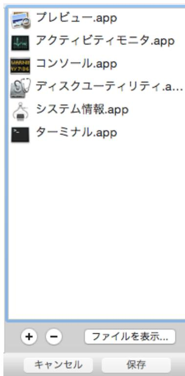
「+」ボタンをクリックすると、ファイル選択ダイアログが開き、追加したいユーティリティのファイルあるいはフォルダを選択できます。選択したユーティリティは、「アプリケーション」フォルダ内の「ユーティリティフォルダ」に保存されます。「-」ボタンをクリックすると、選択しているユーティリティをリストから削除します。「ファイルを表示」をクリックすると、選択したファイルやフォルダのオリジナルの保存場所が Finder に表示されます。
