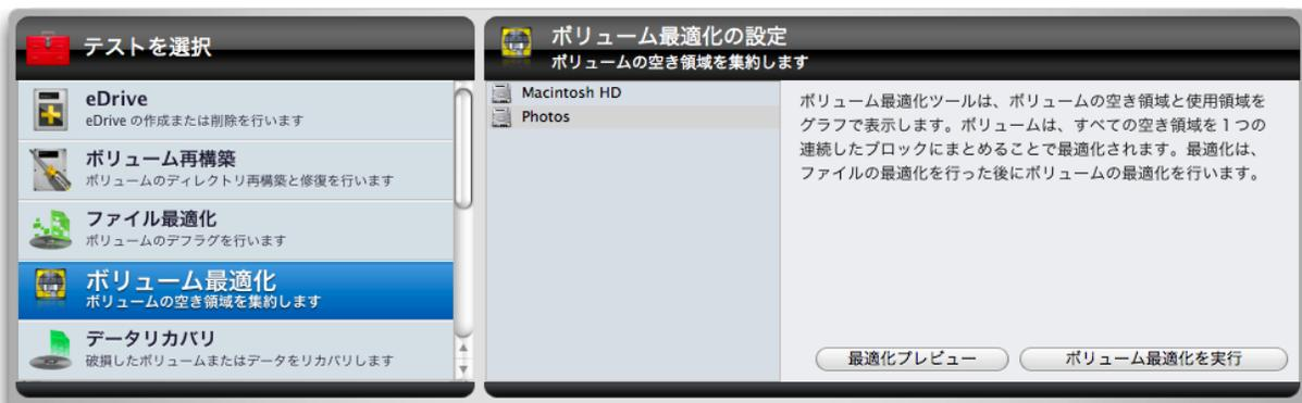
左側のボリュームリストから検査または最適化するボリュームを選択します。「最適化プレビュー」ボタンをクリックすると、ステージにボリュームの情報と使用状況がグラフで表示されます。
