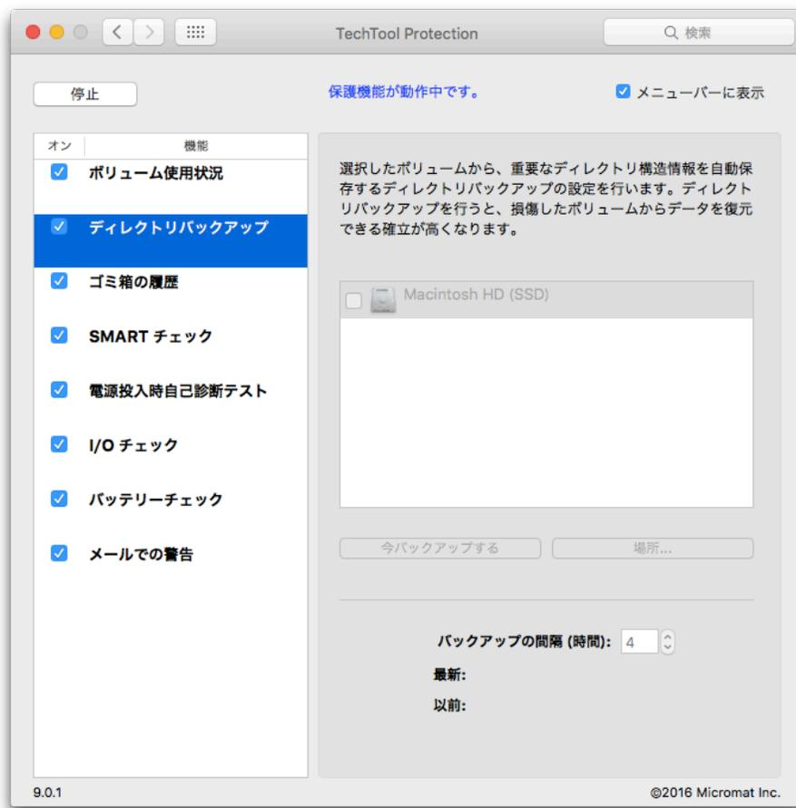
「オン」ボタンをクリックしてディレクトリバックアップを有効にします。保護したいボリュームのチェックボックスをオンにします。「バックアップの間隔」にバックアップを行う間隔を設定します。選択されているボリュームのディレクトリのバックアップを直ちに行うには、「今バックアップする」ボタンをクリックします。ディレクトリバックアップを複数の場所に保存する場合には、「場所...」ボタンをクリックして、ディレクトリバックアップを行う場所を追加します。
