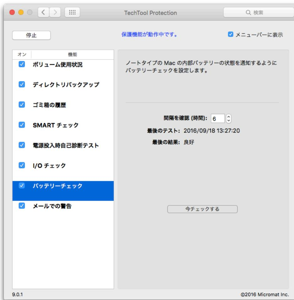
TechTool Protection パネルの「バッテリーチェック」をクリックして「バッテリーチェック」画面を表示します。最新のテスト結果が表示されます。「今チェックする」をクリックすると、再びテストを実行します。「間隔を確認」フィールドでバッテリーをチェックする間隔の時間を設定できます。
