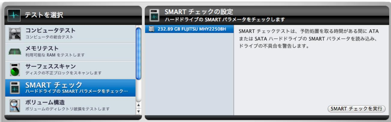
左側のドライブレリストから、テストを行うドライブを選択します。「SMART チェックを実行」ボタンをクリックして、テストをキューに追加します。テストが実行されると、ステージの左側にデバイス上のボリュームと、テストされているデバイスの名前が表示されます。右側には、個々の SMART パラメータの結果がグラフで表示されます。
