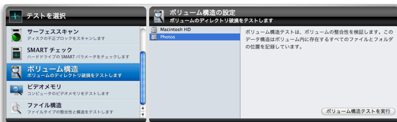
テストするボリュームを選択して「ボリューム構造テストを実行」ボタンをクリックして、テストをキューに追加します。
