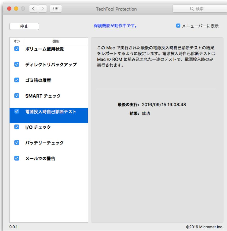
電源投入時自己診断テストは、システムログに記録された最新のテスト結果を表示します。
