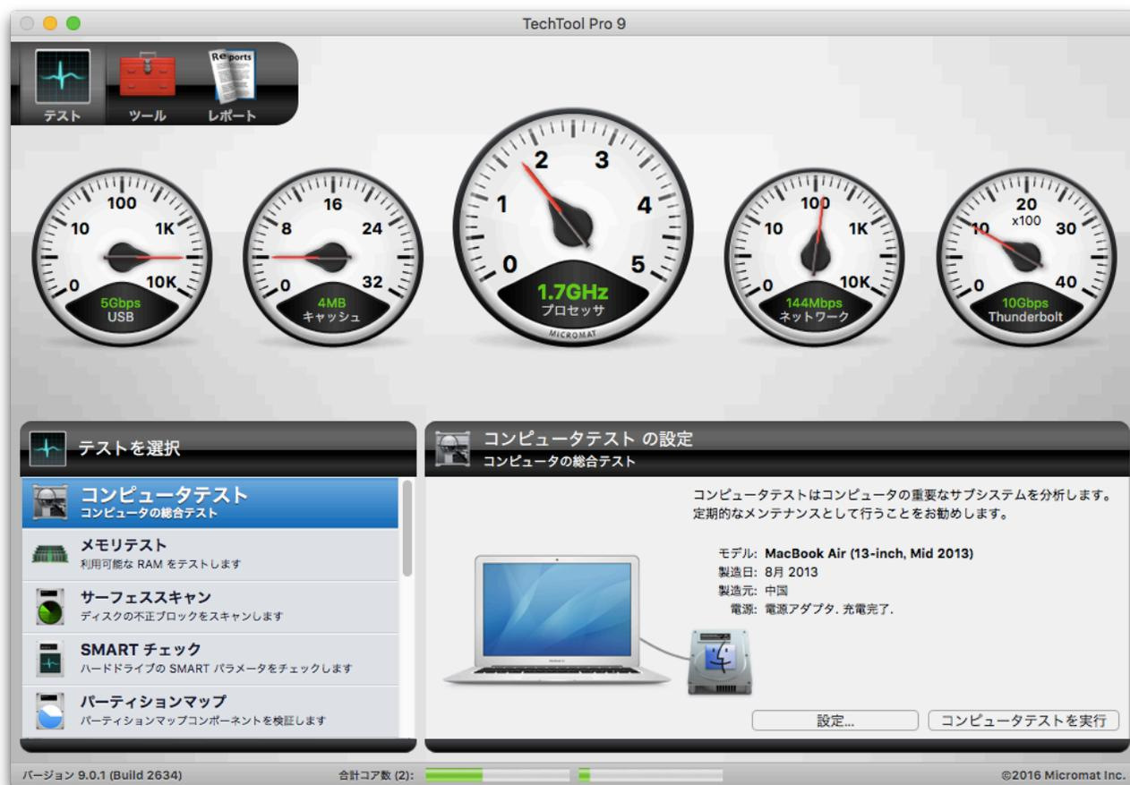
TechTool Pro を起動すると、自動で5つのハードウェアの検査が行われます。検査結果は、ステージ上のメーターに表示されます。
