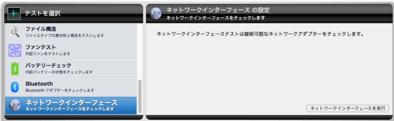
テストは利用可能なネットワーク接続を循環します。対象となるネットワークアダプターの分類は、Ethernet、WiFi、FireWire、BluetoothとVPNになります。その他のアダプターもテストされますが、前述のいずれかに分類されます。一例として、USBとThunderbolt EthernetアダプターはEthernetに分類されます。
