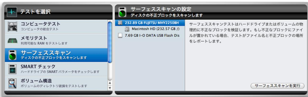
コンピュータに認識されている、すべてのハードドライブが設定画面の左側に、ドライブ名の右下に表示されるパーティションと一緒に表示されます。テストを行いたいハードドライブまたはボリューム（特定のパーティション）を選択して、「サーフェススキャンを実行」ボタンをクリックすると、キューにテストが追加されます。テストが実行されると、ドライブから読み込まれているデータがステージの中心に表示されます。
