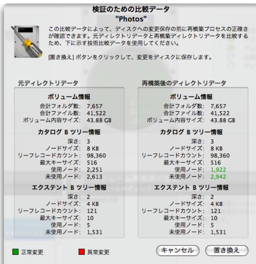
技術比較データには、元のディレクトリと、新しく作成されるディレクトリの重要な技術情報が表示されます。この中には、フォルダやファイルの総数など、詳細な情報があり、ディレクトリの再構築を行うかどうかを決める手助けになります。ディレクトリ間の違いは色で表示されます。緑は正常の変化、赤は問題を含んでいる可能性のある変更を示します。「置き換え」ボタンをクリックすると、元のディレクトリを新しく再構築したもので置き換えます。「キャンセル」ボタンをクリックすると、元のディレクトリに戻します。
