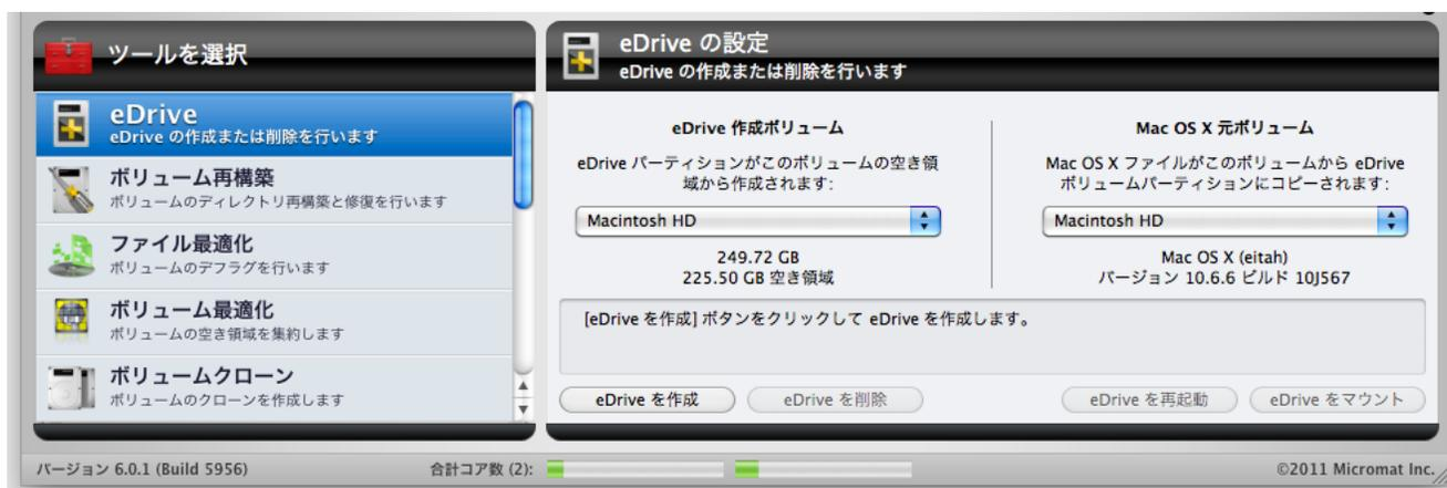
「eDrive 作成ボリューム」ポップダウンメニューで eDrive を作成したいボリュームを選択します。起動ボリュームまたは外部のボリュームが選択できます。ポップダウンメニューの下に、ボリュームのサイズと空き領域が表示されます。
