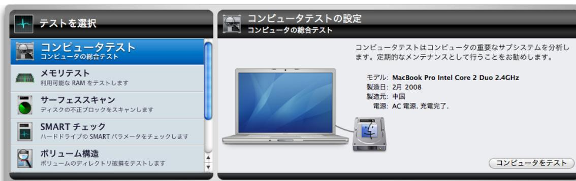
「コンピュータテストの設定」ウィンドウでは、お使いのコンピュータの画像と製造日が表示されます（コンピュータのロジックボードを交換していると表示されないことがあります）。コンピュータに接続されているハードドライブのアイコンも表示されます。マウスのカーソルをアイコン上に置くと、ドライブ識別情報、接続タイプ、ボリューム情報がツールチップに表示されます。
