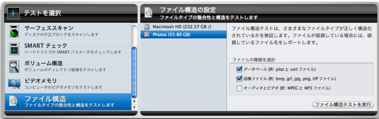
「ファイル構造の設定」画面では、コンピュータに接続された Mac でフォーマットされたボリュームをリストします。テストするボリュームを選択し、右側のオプションからテストするファイルタイプをチェックしてください。テストできるファイルタイプは以下のとおりです。
