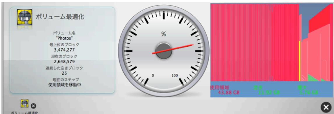
ステージにはデータの分布状況と空き領域が棒グラフで表示されます。高いグラフがより多くのデータをドライブ中のその位置で保持していることを表します。最適化が進むと、現在最適化されている位置が黄色の棒グラフで点滅します。ボリューム最適化は、すべてのデータをボリュームの最初のエリアに移動し、すべての空き領域を後ろのエリアに移動します。
