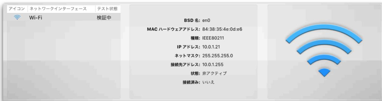
ネットワークインターフェーステストは、テストするネットワークインターフェース毎に、成功または失敗のテスト結果をレポートします。個々のネットワークインターフェースのテスト結果は、ステージ上のテーブルにレポートされます。
